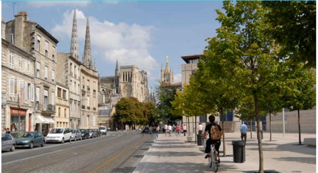
Le tramway est généralement inséré en site propre, isolé des voies de circulations par une bordure élevée infranchissable pour les voitures. Il peut être en site semi-banalisé lorsque la largeur des rues est insuffisante.
